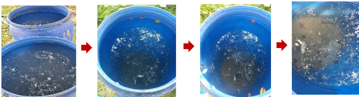
รูปที่ 1 การทดสอบการลดปริมาณสาหร่ายด้วยสารส้มและดินเหนียว ด้วยการจำกัดพื้นที่ ในถังพลาสติก ขนาด 200 ลิตร
